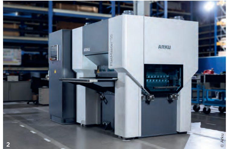
1 Mit dem EdgeBreaker 3000 Next bringt Arku eine neue Generation von Entgratmaschinen für Stanz- und Laserteile auf den Markt. 2 Mit der Richtmaschine FlatMaster 55 werden Blechteile in Sekundenschnelle eben, wie Arku auf der Euroblech zeigen wird.
