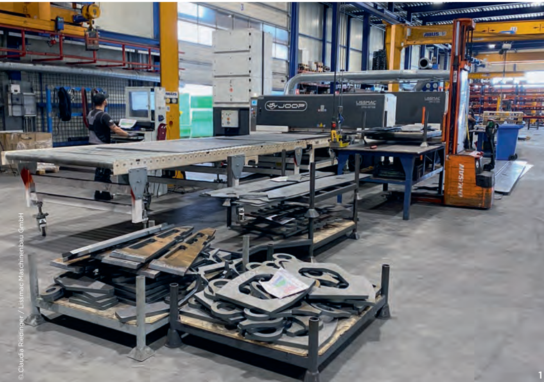
1 Das Stahlservicecenter Joop van Zanten ist Komplettanbieter für Plasma- und Autogenschnitten. Bearbeitet werden Stahlbleche von 2 mm bis 300 mm; dazu kommt Bohren und Gewindeschneiden, Abkanten, Richten, Strahlen und Schweißen. 2 Die bei Joop van Zanten gefertigten Teile durchlaufen alle die Lissmac-Anlage. Zwischenzeitlich sind die entgrateten und verrundeten Teile ein Qualitätsmerkmal für das Unternehmen geworden, welches die Kunden zu schätzen wissen.
