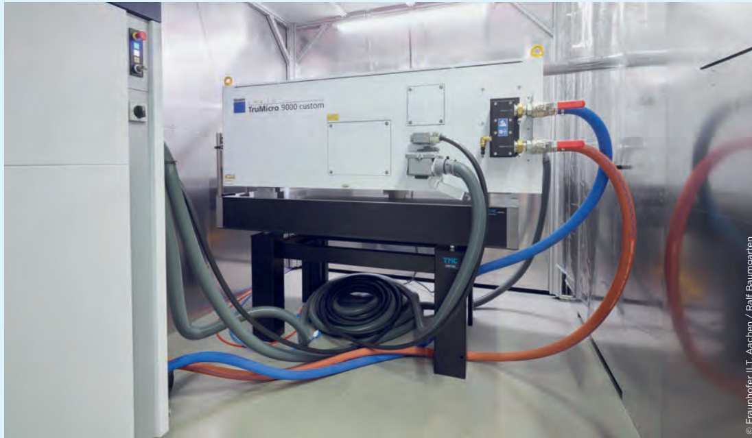
Trupf TruMicro 9000: Der weltweit erste industrielle 1-KW-UKP-Laser steht in der User-Facility des Fraunhofer Clusters of Excellence Advanced Photon Sources CAPS im Fraunhofer ILT in Aachen.
