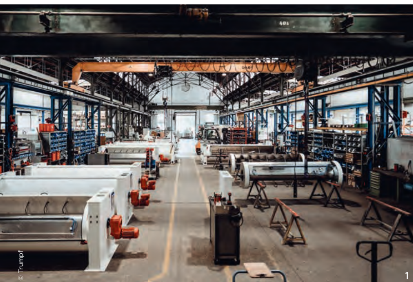
1 Kerngeschäft: In der historischen Fertigungshalle stellt Cimbria Heid Trieure her, Maschinen zum Sortieren von Saatgut und Getreide.
