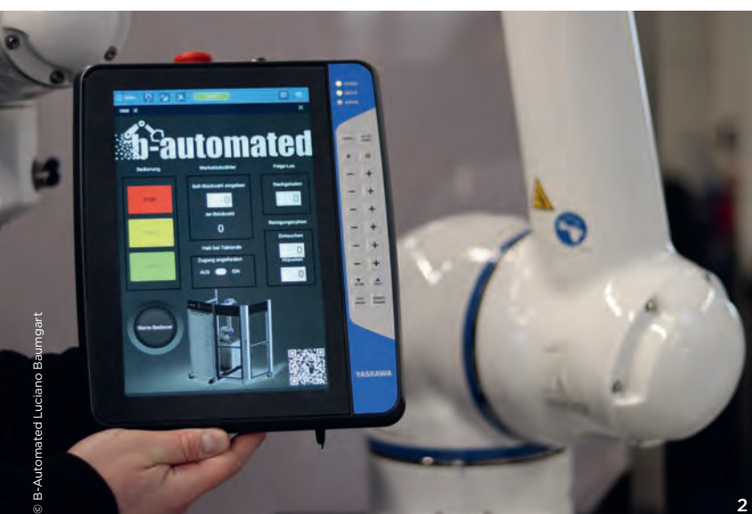
1 Herzstück der Gesamtlösung zur Automatisierung einer Drahterodiermaschine ist ein Cobot HC10DTP von Yaskawa.
