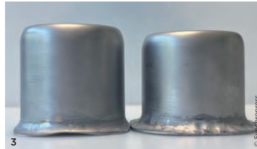
3 Vergleich mit (linkes Teil) und ohne (rechtes Teil) pulsierende Kraft (beide Teile mit wegbhängiger Kraft): rechts ohne pulsierende Kraft unmittelbar vor dem Bodenreißer; das linke Teil mit pulsierender Kraft wird im nachfolgenden Arbeitsgang weiter verformt (eckig ziehen), ohne Bodenreißer.
