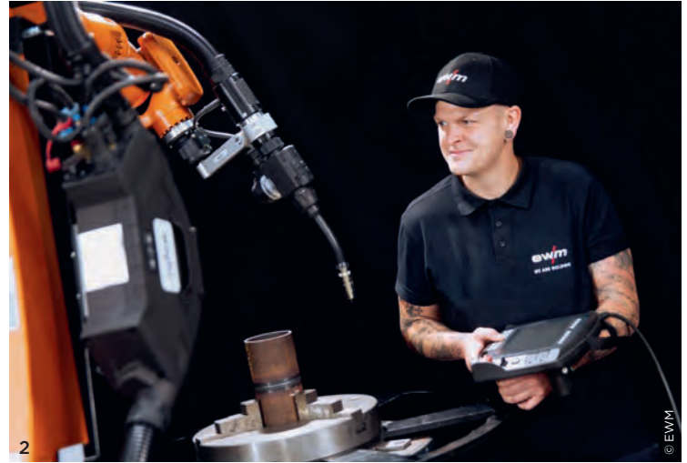
1 „React“ steht für Reversing actively controlled transfer. Der Name beschreibt einen Schweißprozess mit reversierender Drahtbewegung.
