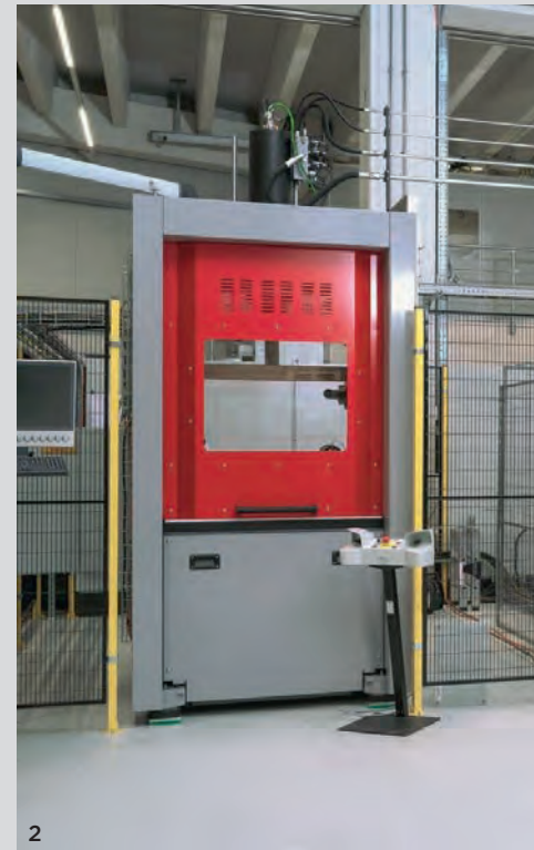
1 Schuler bietet für das Backlack-Verfahren ein schlüsselfertiges Gesamtsystem mit einer Schnellläuferpresse an. 2 Die Elektrobleche werden dabei in einer Backstation der SWD AG unter Druck und hoher Temperatur zusammengefügt.
