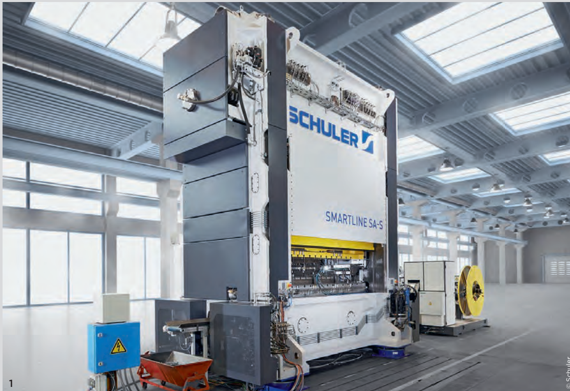
1 Schuler bietet für das Backlack-Verfahren ein schlüsselfertiges Gesamtsystem mit einer Schnellläuferpresse an. 2 Die Elektrobleche werden dabei in einer Backstation der SWD AG unter Druck und hoher Temperatur zusammengefügt.
