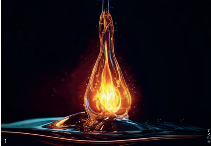
1 „React“ steht für Reversing actively controlled transfer. Der Name beschreibt einen Schweißprozess mit reversierender Drahtbewegung.
