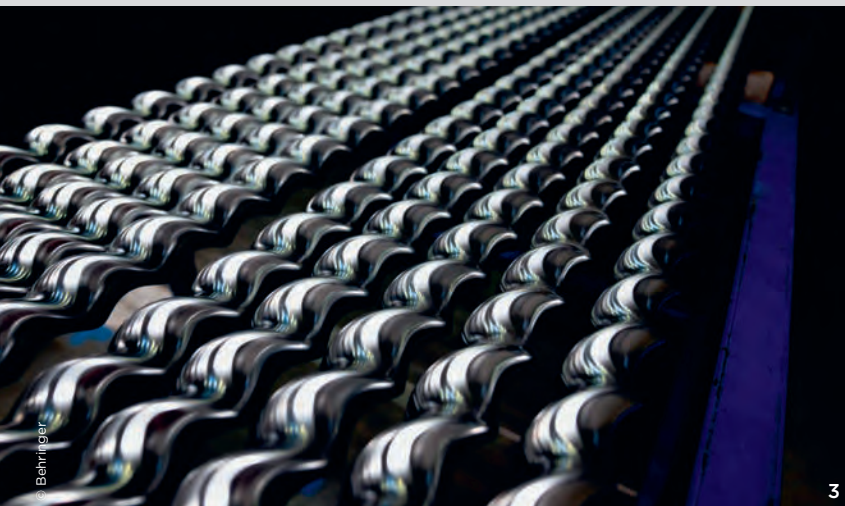
1 Das Pick-System entnimmt den Stab aus der Lagerkassette und plaziert ihn auf dem Pendelrollgang zur Säge. 2 Der Hallenkran wird nur noch für die Entnahme der gesägten Anschnitte verwendet. 3 Aus dem Rohmaterial produziert Netzsch unter anderem solche Rotoren für die Exzenter-schneckenpumpen. Nach dem Ablängen des Rohmaterials im Sägezentrum wird der Stab in der Drehmaschine bearbeitet und anschließend gewirbelt. 4 Ein geschlossener Materialtisch für kurze Abschnitte sowie offene Lagerplätze für lange Stäbe befinden sich abfahrseitig an der Säge.
