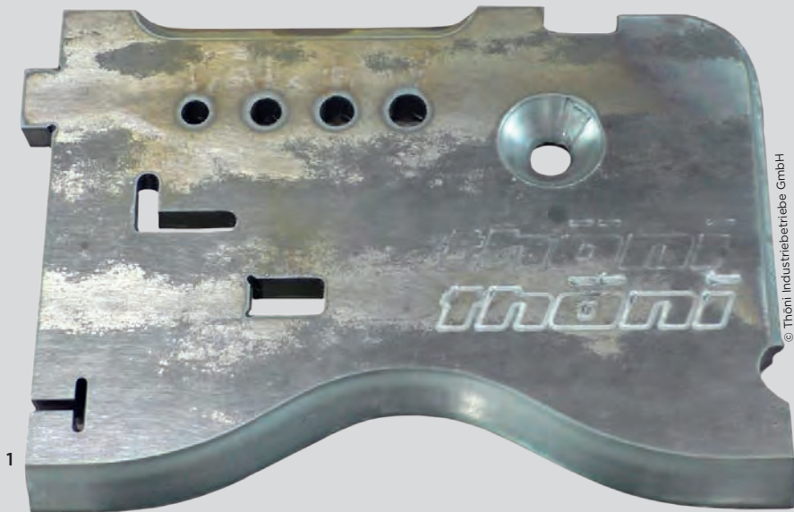
1 Saubere Schnitte, Fasen bis 50°, schmale Einschnitte und kleine Lochdurchmesser ermöglicht die MultiTherm. 2 Die neue Brennschneidmaschine MultiTherm von Messer Cutting Systems mit Plasma-Fasenaggregat, Alfa-Autogenbrenner und Rohrschneidsystem.
