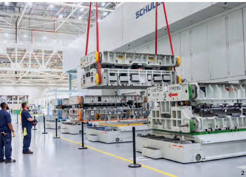
1 Schuler ist auf der Fachmesse Euroblech in Hannover vom 22. bis 25. Oktober 2024 auf Stand G82 in Halle 27 zu finden. 2 Werkzeuge für die neue Schuler-Pressenstraße bei BMW Spartanburg
